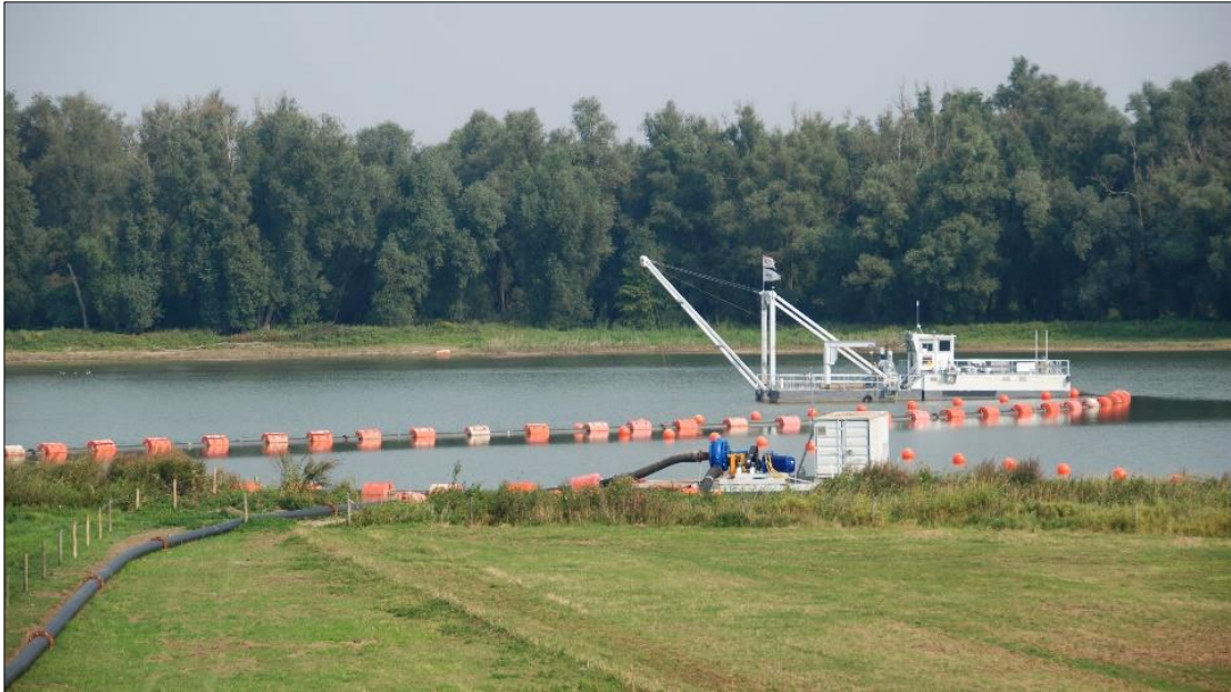
Figuur 7. Het winwerktuig “DOS 3” met persleidingen.
